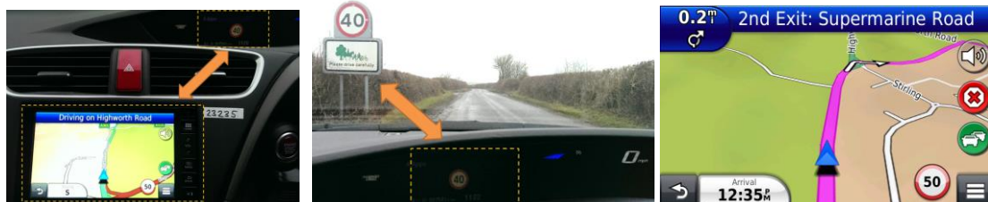
Geschwindigkeitsbegrenzung der Navigation & TSR i-MID TSR Geschwindigkeitsangaben Geschwindigkeitsbegrenzung stammt aus Navigationsdatenbank
